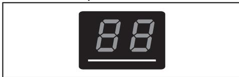
Muestra las cifras del temporizador minuterio autónomo y del temporizador para la cocción temporizada.
