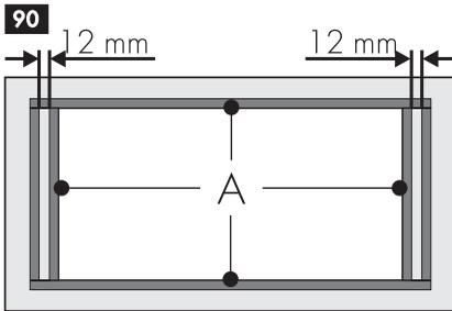
2. Adhiérela, con una ligera presión, a la superficie del perímetro exterior de la abertura realizada en la encimera superior.
