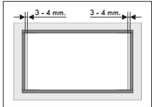
2. Adhiérala, con una ligera presión, a la superficie del perímetro exterior del orificio perforado en la encimera; los lados delantero y trasero de la junta deben quedar al ras del orificio.
