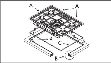
Este modelo de empotrado exige cortar la encimera superior a una profundidad de 3 mm (elemento «B» de la figura anterior). Antes de colocar el aparato, es necesario cortar la junta aislante suministrada (C).
