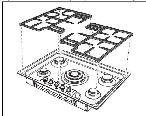
Asegúrese de que las rejillas estén simplemente centradas sobre sus respectivos quemadores sin forzarlas a quedar levantadas o inclinadas; en tal caso repita la colocación.
