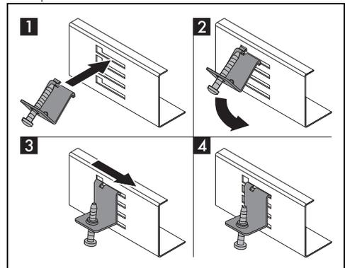
3. Apoye la encimera sobre la junta aislante y mediante los tornillos y las abrazaderas de fijación suministradas (A), fije la encimera a
