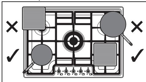
Durante la cocción, para evitar que la encimera o la placa de cocción se quemen o dañen, todos los recipientes o las planchas deben estar situados dentro del perímetro de la encimera de cocción.
