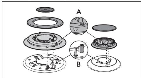
Antes de encender los quemadores de la encimera, verifique que los difusores de llama estén colocados en sus alojamientos con sus tapas correspondientes. Asegúrese de que los orificios 1 de los difusores de llama coincidan con las bujías 3 y los termopares 2.
