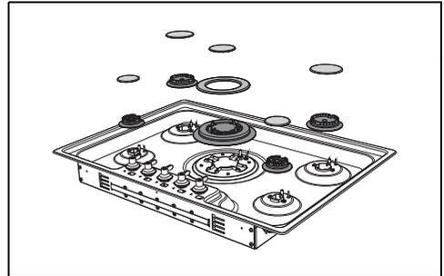
3. Suelte los inyectores de los quemadores con una llave de tubo de 7 mm y sustitúyalos en función el gas que vaya a emplearse (véase "Tablas de características de quemadores e inyectores").
