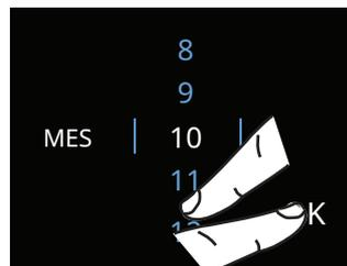
D) Deslizar hacia arriba o abajo para seleccionar el mes deseado y tocar **OK**.
