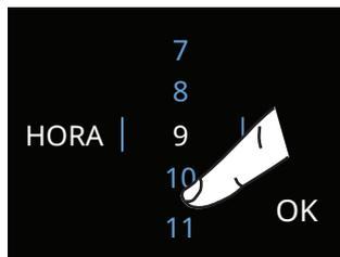
D) Deslizar hacia arriba o abajo para ajustar el tiempo deseado (en horas) y pulsar **OK**.
