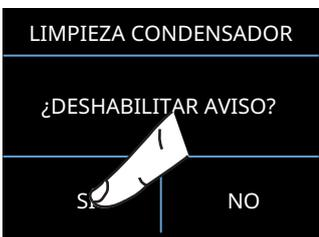
**F)** Esta señal de aviso se puede desactivar y visualizar el tiempo residual hasta la próxima limpieza tocando el botón **SÍ**.
