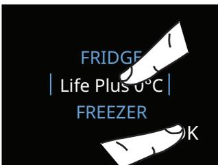
**C)** Deslizar hacia arriba o abajo y seleccionar una de las tres funciones y pulsar **OK**.
