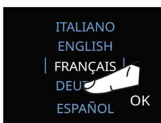
**C)** Deslizar hacia arriba o hacia abajo para seleccionar el idioma deseado y pulsar **OK**.
