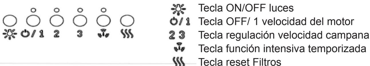
La función intensiva temporizada es la modalidad de servicio para la cual, por un tiempo limitado, la campana elabora su capacidad máxima. La activación de la función se muestra a través del parpadeo del diodo luminoso
